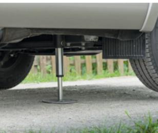
Mit den hydraulischen Hubstützen der Pro-Serie nivellieren Sie Ihr Reisemobil ganz einfach und zuverlässig in die gewünschte Position. Mit Hilfe des praktischen Automatik-Modus genügt ein Tastendruck, um das Fahrzeug in die Waagrechte zu stellen und stabil abzustützen. Zusätzlich erlaubt es das Goldschmitt-System, Stützenpaare oder einzelne Hubstützen manuell anzusteuern. Somit bleiben Sie jederzeit flexibel. Je nach Bedienvariante lassen sich weitere praktische Posi-
