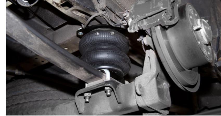
Der Einbau der Zusatzluftfederung dauert beim blattgefederten Fiat Ducato etwa vier Stunden. In dieser Zeit werden Luftbälge, Kompressoreinheit und Bedienteil montiert sowie Kabel und Luftschläuche verlegt und angeschlossen. Anschließend erfolgt die TÜV-Abnahme ebenfalls im Goldschmitt Technik-Center.
