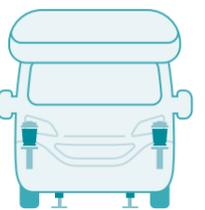
Im oberen Bild befindet sich die Luftfederung im normalen Fahrmodus, während das untere Bild das Fahrzeug mit abgesenkter Luftfederung zeigt. Im abgesenkten Zustand haben die Hubstützen einen deutlich geringeren Weg zu bewältigen. Dadurch können größere Differenzen ausgeglichen und das Fahrzeug stabiler abgestützt werden.
