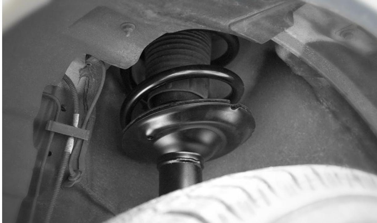
**Ressorts hélicoïdaux de remplacement pour l'essieu avant**
