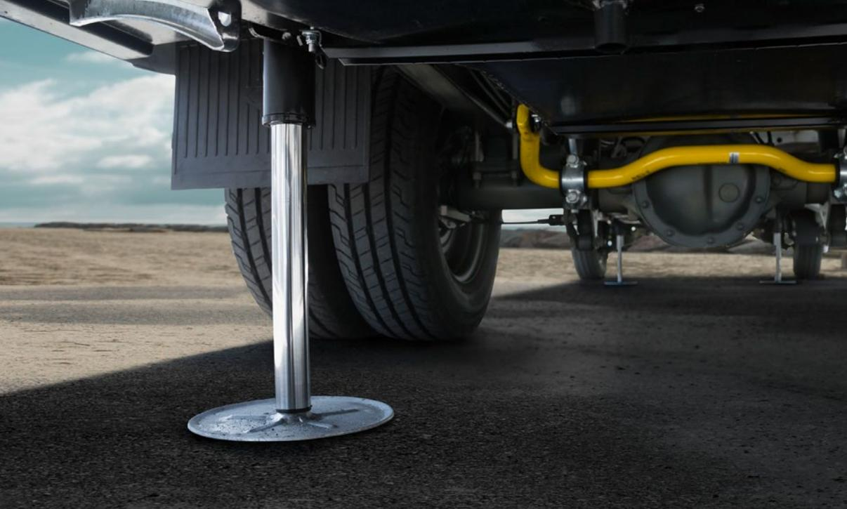
En fonction du type de véhicule, nous pouvons vous proposer trois versions de vérins : Tele-Star, Swing-Star et Vertical-Star. Le groupe hydraulique central est placé à l'intérieur du camping-car et il est ainsi protégé contre les dommages provoqués par les intempéries. La commande d'urgence de série permet de l'actionner manuellement à l'aide de la pompe manuelle.
